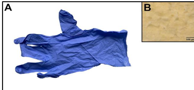
Figure 39 : Photographie d'un gant (A) utilisé comme EPI par l'entreprise A à base de poly(acrylonitrile butadiène) (NBR). Photographie d'un fragment bleu de NBR (B) isolé dans un échantillon de produit fini.
