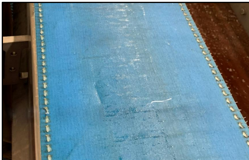
Figure 37 : Photographie d'un tronçon de tapis de convoyage bleu utilisé entre les étapes 1 et 2 du processus de transformation de maquereaux par l'entreprise A.
