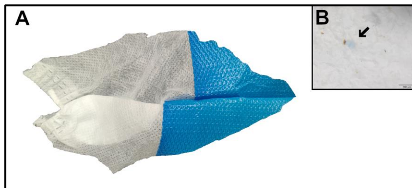
Figure 50 : Photographie d'un fragment de surchausse gant (A) utilisé comme EPI par l'entreprise D dont le revêtement bleu est composé de PP. Photographie d'un fragment bleu de PP (B) isolé dans un échantillon de produit fini.
